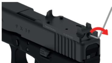
Ziehen Sie die Feststellschraube der MAKnetic auf 1,5 Nm an.
